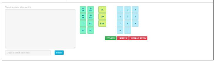
PJE NUVEM - MÓDULO 4: Digita-se a direção e o tempo com o teclado do computador/dispositivo e depois se envia o ao robô. É possível revisar o comando e criar uma lista de comandos antes do envio.
